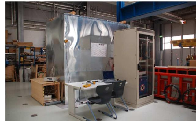
Radiowellenanlage im Technikum zur dielektrischen Erwärmung
