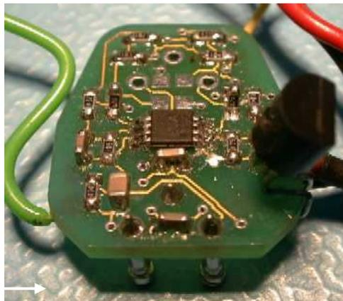
Abbildung 27 Vorverstärkerplatine
